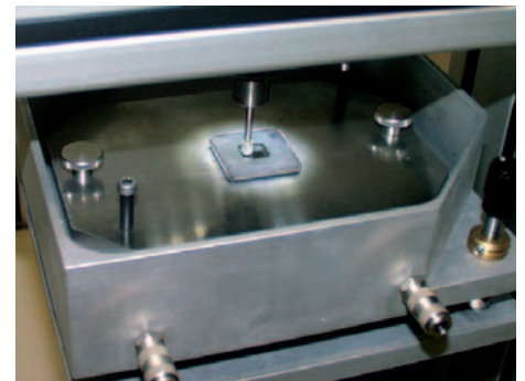
Abb. 1 Verfahrbarer Tisch des Rückseitentools mit mikroelektronischen Bauelement.
