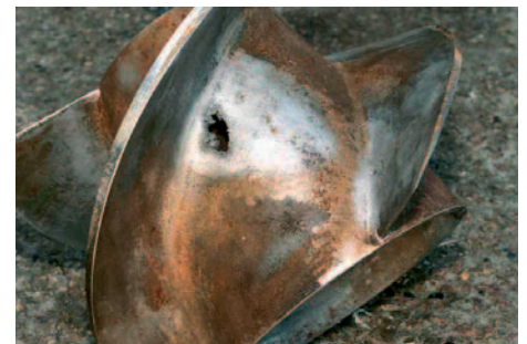
Abb. 1 Kavitationsschaden an einer Schiffschraube (Institut de Recherche de l'Ecole Navale, Frankreich).
