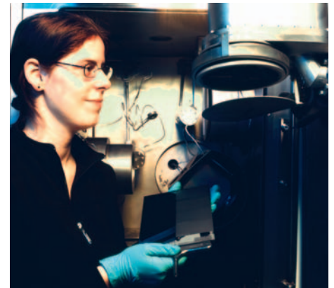
Abb. 1 Herstellung metallisch anmutender, dekorativer Schichten auf Kunststoff mit ionenstrahlgestützten Prozessen.
