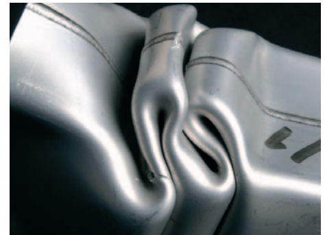
Geschweißtes Al-Profil nach Crashbeanspruchung
