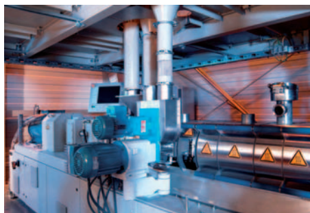
Schwerpunkt des Fraunhofer IWM im PAZ ist die Polymerverarbeitung. Die Abbildung zeigt einen Compounder.
