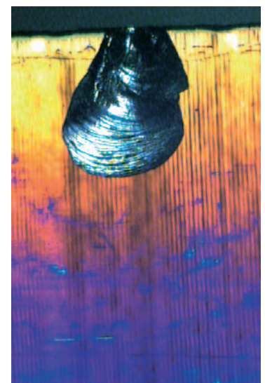
Abb. 2 Absplitterung an einer Waferkante als Folge eines Handlingfehlers (Anschlag des Wafers auf einem Stopperstift).
