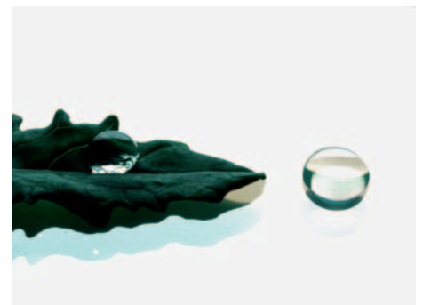
Abb. 2 Transparente Wasser abweisende Schichten nach dem Vorbild der Natur. Links: Tropfen auf stark Wasser abweisender Blattoberfläche. Rechts: Tropfen auf nanostrukturierter IWM-Beschichtung auf Glas.
